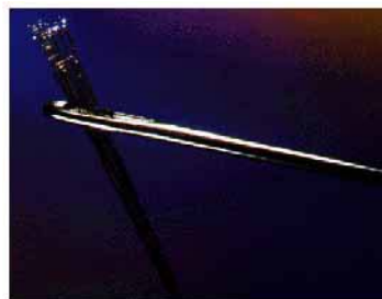
zuntz optikoaren eta jostorraz baten arteko konparazioa (iturrria: http://neo.lcc.uma.es )
